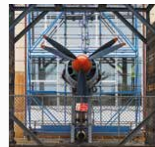
Stort vindue testes for vejrbestandighed (vind-og vandtest) med en flymotor.
