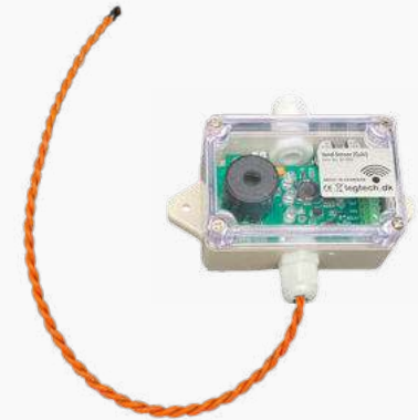
Leak detector m/Vand sensor kabel Reagerer -> når vand rammer orange kabel. Tilslutning: 12-24VDC, med Buzzer lyd og led Blink Med potentialfri relæ-udgang til PLC el. andet. - Vand kabel max. 10 meter.
